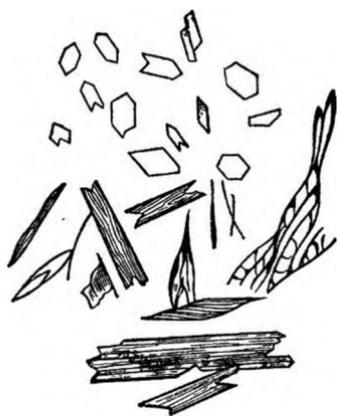
Рис. 22. Кристаллы хлорида свинца ( $\times 60$ )
